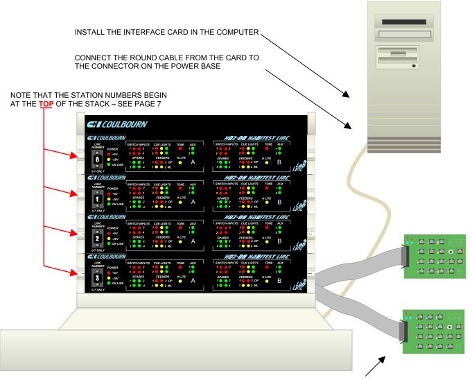
CONNECT 1 OR 2 ECB(S) TO EACH LINC USING THE FLAT CABLES
